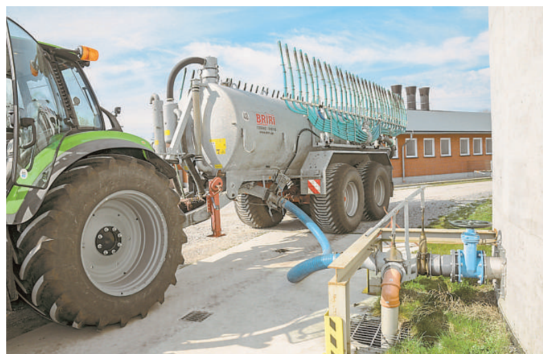
Kleine Maßnahmen wie ein Anfahrtschutz können Unfälle vermeiden helfen.
